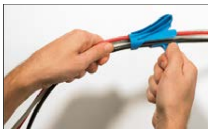
Insérer un ou plusieurs câbles dans l'outil HAT.
