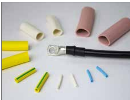
Nos manchons se posent à l'aide d'une pince à manchonner et peuvent s'élargir jusqu'à 5 fois leur taille initiale.
