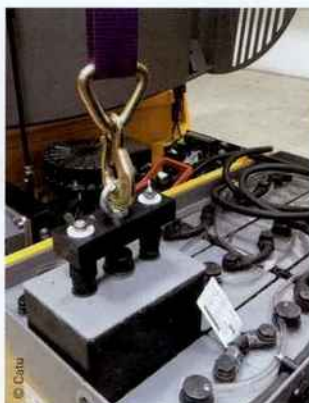
L'accessoire MO-810 de Catu, pour déposer et extraire les batteries.
