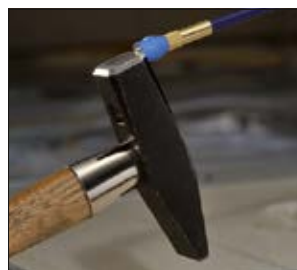
L'aimant est capable de soulever des objets métalliques pesant jusqu'à 2,5 kg.
