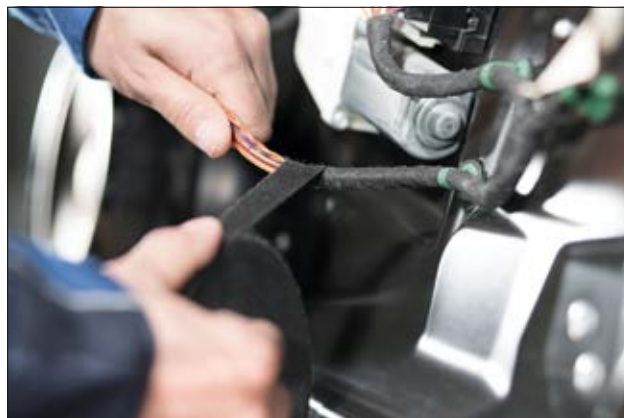
Helatape Protect 250 - Conçu pour le frettage de câbles et fournit une très haute résistance à la température.
