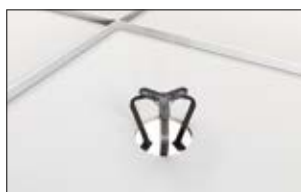
1. Comprimez les pattes de montage et insérez le SpotClip-Kit dans la découpe du plafond.
