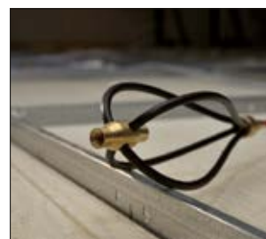
Le fouet permet de glisser facilement les câbles sur les obstacles.
