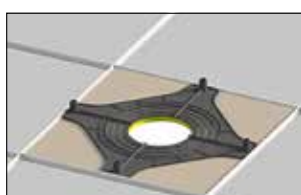
2. Découper le faux plafond en fonction du diamètre retenu.
