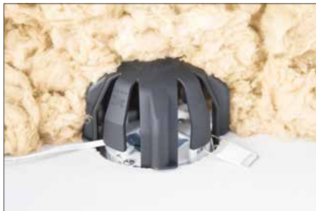
Les 4 languettes supplémentaires du SpotClip-IV Slim permettent d'éviter tout contact entre le spot LED extraplat et l'isolation soufflée.
