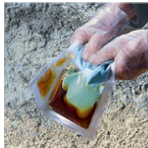
Le joint entre les deux compartiments résine et durcisseur cède par simple pression
