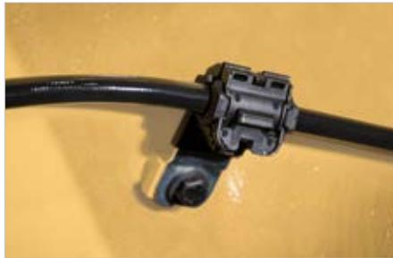
Le corps en plastique de la bride en polyamide 6.6 modifié chocs, haute température et résistant aux UVs a été conçu pour maintenir durablement câbles et tuyaux. Dotée d'une charnière renforcée par 3 ergots et d'un système de verrouillage par double crantage, la bride Ratchet P-Clamp surpasse les exigences attendues et espérées.
