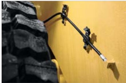
La fixation de la bride Ratchet P-Clamp sur le support s'effectue à l'aide d'une vis ou d'un goujon dont le trou de passage est situé sur la patte métallique pour l'application d'un couple de serrage élevé. Une fois les brides vissées sur le panneau et correctement alignées, les câbles peuvent être mis en place avant la fermeture de chaque Ratchet P-Clamp et ainsi optimiser le temps nécessaire au routage.
