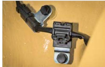
La patte de fixation en acier galvanisé est traitée pour résister aux agents chimiques. Son revêtement est conforme à la directive RoHS. Cette patte de fixation métallique permet d'appliquer un couple de serrage élevé pour une installation robuste et sécurisée.
