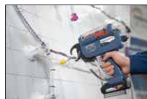
Fixation de colliers de serrage en bobine avec l'autotool CPK sur batterie, maintenu via une potence.
