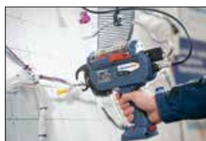
Autotool CPK hybrid avec alimentation et potence.
