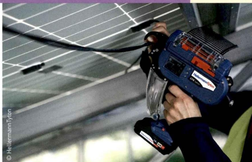
CPK hybrid : l'outil de pose de colliers automatique et autonome.
