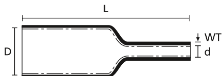
Gaine thermorétractable 4:1 avec adhésif
