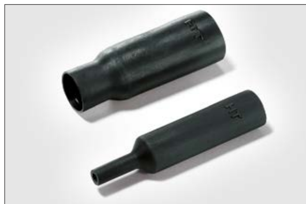
Série 313E445-457, avant et après rétreint.
