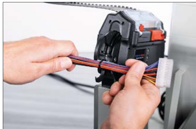
Application de frettage avec l'AT2000CPK installé sur le banc fixe.
