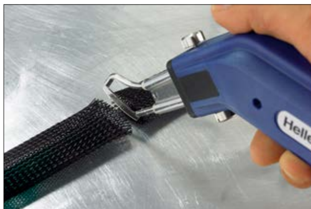
L'outil de coupe HSGO évite l'effilochage des gaines tressées ou tissées.
