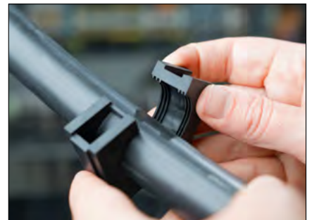
Les nervures flexibles dans les trous des inserts compensent jusqu'à 0,4 mm de tolérance le diamètre du câble
