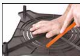
Couper à l'aide d'une lame de scie à métaux les 8 ergots qui maintiennent la zone à enlever.
