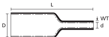
Gaine thermorétractable 4:1 avec adhésif
