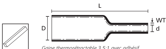
Gaine thermorétractable 3,5:1 avec adhésif
