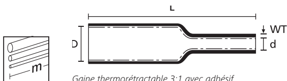
Gaine thermorétractable 3:1 avec adhésif
