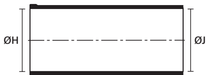
a: forme expansée (avant rétreint)
