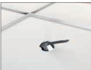
1. Comprimer les pattes de montage et insérer le SpotClip-III dans la découpe du plafond.
