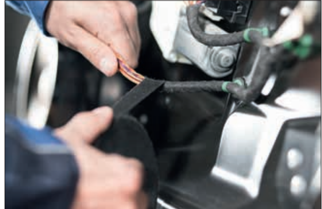
Helatape Protect 250 est conçu pour le frettage de câbles et fournit une très haute résistance à la température.
