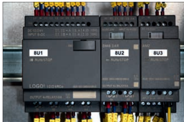
Des étiquettes clairement identifiées garantissent une gestion facile des fils et des câbles réseau.
