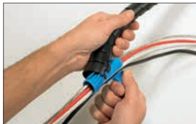
Placer l'extrémité de la gaine dans l'outil.
