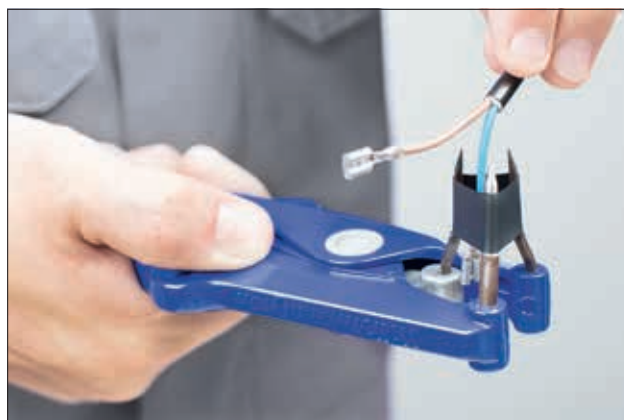
Mise en œuvre rapide et sécurisée grâce à nos outils d'expansion à 3 becs.
