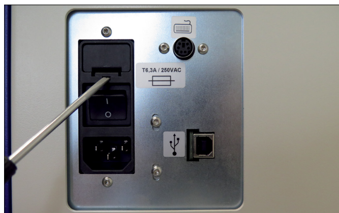
Remplacement du fusible d'entrée secteur.
